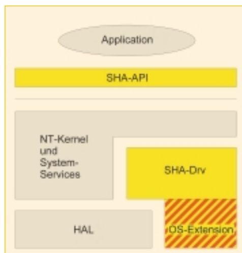
Abb. 3: Modelldarstellung der Zusammenarbeit von Betriebssystem, Echtzeiterweiterung und Anwendung
