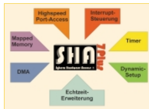
Abb. 4: Das Echtzeitsubsystem Sybera Hardware Access
